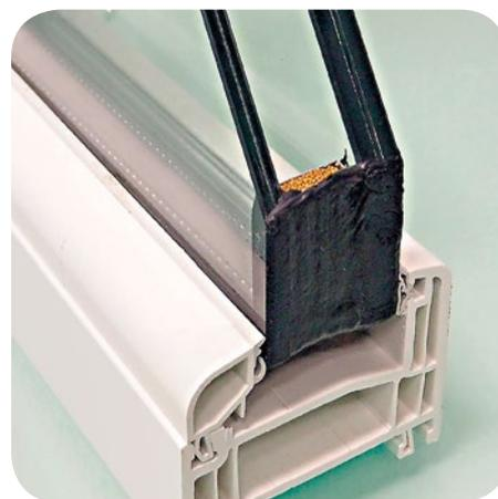
**Vetro in classe P4A**, nel nostro caso BE 33.1/18/55.4. La sigla indica una vetrocamera con trattamento basso emissivo composto da un vetro stratificato composto da due lastre di 3mm unite da una pellicola in PVB, una camera d'aria di 18mm e da un vetro stratificato composto da due lastre da 5mm con 4 pellicole interne
